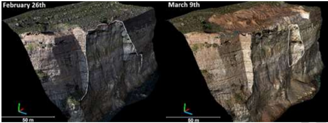
სურათი 3.23. კორინთის არხის ფერდობის ჩავარდნის წერტილოვანი დრუბელი 26 თებერვალს და 9 მარტს Pix4d-დან.
